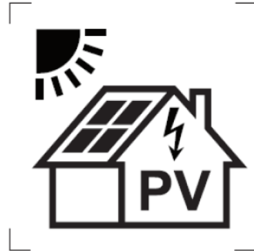
Figur 2: Märkningen som anger att det finns solceller installerade i en fastighet.
