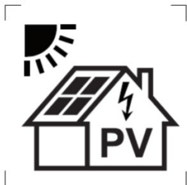
Figur 2: Exempel på märkning som anger att solceller är installerade på en byggnad.
